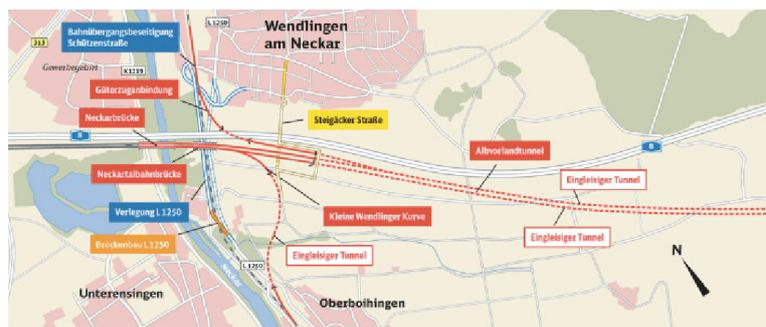
In diesem Plan sind die wichtigsten Bauwerke im Zusammenhang mit dem Neubau der ICE-Strecke bei Wendlingen enthalten. Plan: DB ProjektBau
